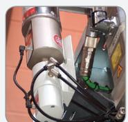
**La pressione a 25 bar consente il montaggio fino a 5 m di distanza per ciascuna uscita**
